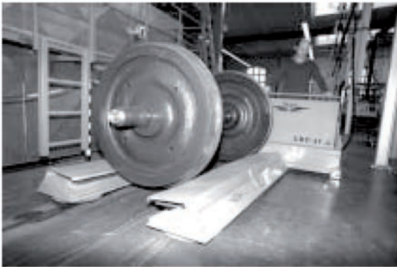
Bild 1: Deutlich sind die Klappen der Schnellhubeinrichtung an der Gabel zu erkennen.
